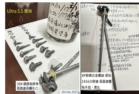
# 記錄 Ultra S.S 螺絲浸泡海水1488小時(2m2d) 無產生銹蝕
