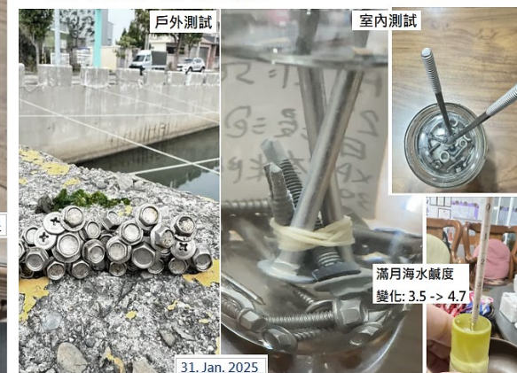
# 記錄 Ultra S.S 螺絲浸泡海水1488小時(2m2d) 無產生銹蝕
