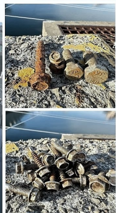
Ultra S.S 防鏽蝕性能測試
