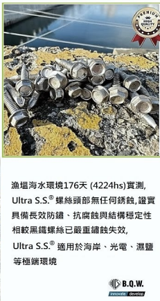
Ultra S.S 防鏽蝕性能測試
