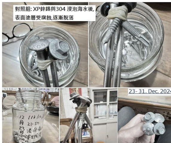
# Ultra S.S. 螺絲經歷連續 1056 小時 (44 天) 於海水及潮汐環境下的測試後，未出現生鏽現象
