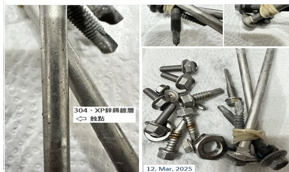
# 304、XP 鋅錫鍍層的頭、身、牙有蝕點/ 1896 小時 Ultra 奈米陶瓷螺絲 BA 牙 鏽蝕/ 1608 小時 CK 牙無鏽蝕(頭部)/2040 小時
